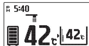
給湯温度が設定できるリモコンに表示します
